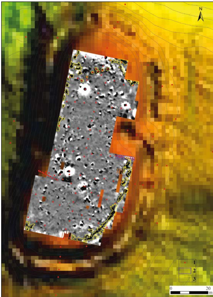
6 pav. Geofizikinių tyrimų magnetograma pagal R. Vengalio (2017) pateiktus duomenis. 1 – gręžinių vietos; 2 – perkastos vieta; 3 – potencialios archeologinės anomalijos. A. Simniškytės brėž.
